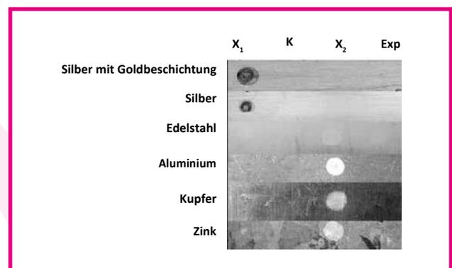
**Abb. 3. Korrosives Potenzial konventioneller DNA-Dekontaminationsmittel im Vergleich mit DNA-ExitusPlus™.** Metalle, wie sie üblicherweise für Laborausstattungen oder Geräte verwendet werden, wurden 20 Minuten mit den Lösungen inkubiert. Kontrolle (K) mit sterilem Wasser; X<sub>1</sub>, X<sub>2</sub> (Wettbewerbsprodukte). Exp (DNA-ExitusPlus™).
